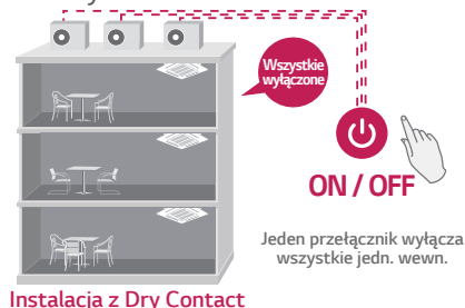
Instalacja z Dry Contact
